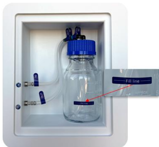
Slika 21.1 Priključitev cevk na steklenico za vlaženje in delovno postajo Multi-Zone ART Workstation
